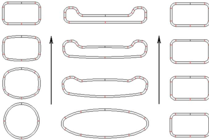
Formrohr-Kalibrierung aus dem Rundrohr (links), aus dem Ellipsenrohr (mitte) und mit unveränderter Querschnittsform (rechts). Die obere Reihe zeigt jeweils das fertige Formrohr; die untere Reihe den Schweißrohrquerschnitt. Die Pfeile weisen in Walzrichtung.
